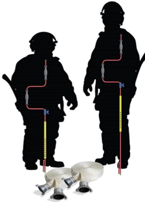
Рис. 4. Устройство, для скатки пожарных рукавов, отрегулированное под рост пожарного
