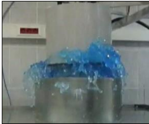
Рис. 2. Фрагмент характерного перелива жидкости через защитную стенку
